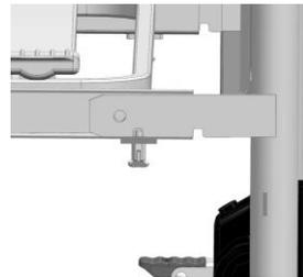
Montieren Sie die Seitensicherungen. Diese können in der diagonalen Stellung verbaut werden. Achten Sie auf die Kennzeichnung „oben“ und „unten“ auf den Stopfen (Endkappen). Damit ist gekennzeichnet, ob es sich um den oberen oder unteren Holm handelt. Der untere Holm ist auch höher ausgeführt.
