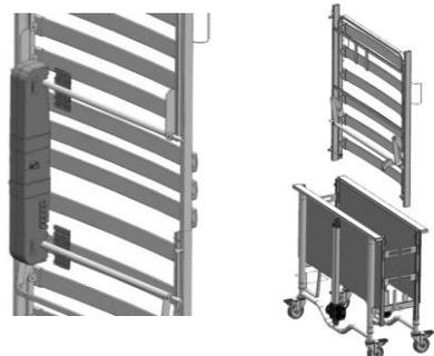
Anschließend die kopfseitige Liegefläche von oben einsetzen. Dabei zeigen die Matratzenbügel nach oben und nach außen.
