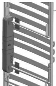
Schieben Sie die Deckplatten seitlich in die Arretierung des Doppelantriebs.
