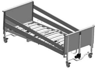
Die Verlängerungen des Rahmens einsetzen und mit der werkzeuglosen Verbindung der Liegefläche arretieren.
