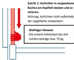
Zur Montage den Aufrichter in die vorgesehene Buchse am Kopfteil stecken und arretieren. Den Triangelgriff in die Halterungsöse einhängen.
