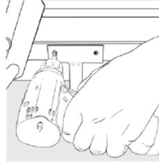
Aufstehbügel in die Halterungstraverse schieben, in die gewünschte Position bringen und fest verschrauben.
