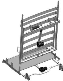
Verbinden Sie die Liegefläche mit dem Endstück, indem Sie die Liegefläche auf die Aufnahmelaschen der Verbinder stecken. Durch leicht diagonales Ansetzen finden sich die Verbindungsaufnahmen leichter und der Aufbau wird rückschönder.
