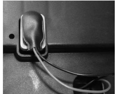
*9-V-Blockbatterie für die Notabsenkung (Doppelantrieb)*
