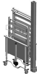
Anschließend die Seitensicherung mit dem Bock-Sicherungsband an der oberen Seite der kopfseitigen Liegefläche fixieren.
