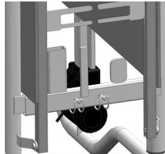
Demontieren Sie den Doppelantrieb, falls vorhanden, indem Sie die Schieber lösen und diesen anschließend zur Seite legen.
