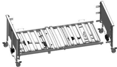
Die neuen Seitensicherungen diagonal einsetzen und das Fußendstück wie gewohnt montieren. Sehen Sie dazu auch die Montageschritte des domiflex® 3.
