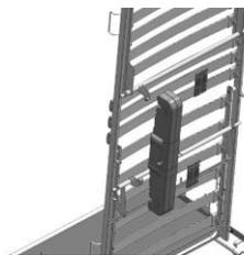
Drücken Sie den Motor über die Motornocken. Die Symbole und die Anschlusskabel müssen nach innen zeigen.
