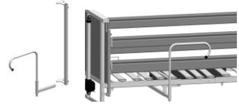
Die Traverse mit den mitgelieferten Schrauben am Liegeflächenrahmen verschrauben.
